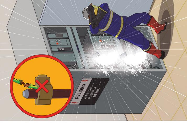
SE PRODUCE CORTOCIRCUITO Y EXPLOSIÓN EN PANEL ELÉCTRICO QUE ALCANZA A TRABAJADOR POR MALA CONEXIÓN A TIERRA
