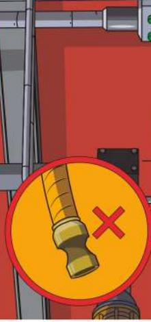
COMPONENTE QUE NO CUMPLE CON LAS ESPECIFICACIONES DEL FABRICANTE ESTA INSTALADO EN EL SISTEMA NEUMÁTICO
