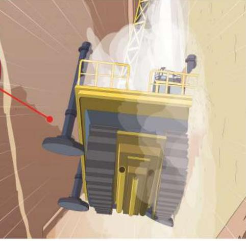
PERFORADORA SE VUELCA DEBIDO A PENDIENTE CON ÁNGULO MAYOR AL PERMITIDO
