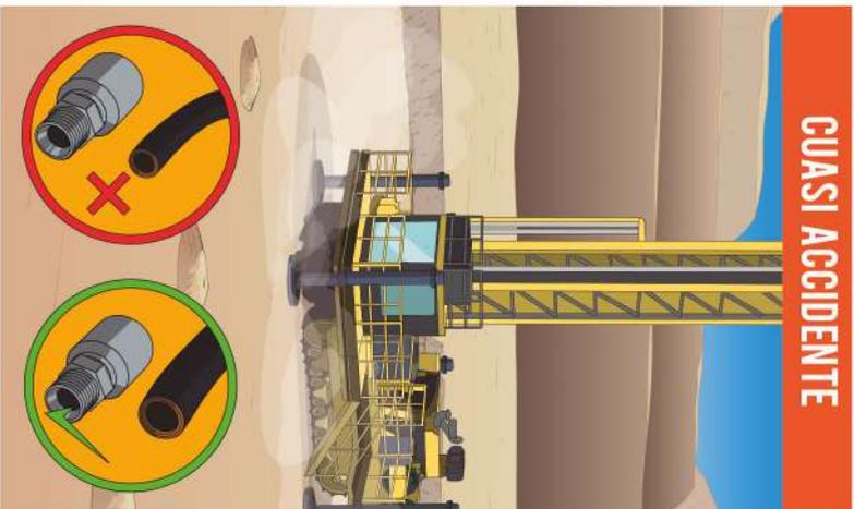
PERFORADORA OPERA CON FÉRULA MAL PRENSADA
